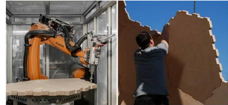
Robotische Vorfertigung der Platten
